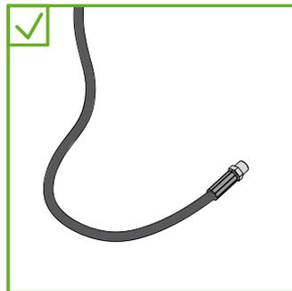
No fuerce las mangueras hidráulicas. Evite curvas cerradas y torceduras. Reemplace las mangueras dañadas de inmediato. No pise las mangueras con vehículos ni coloque objetos sobre ellas. No levante ni transporte los equipos hidráulicos tirando de las mangueras. Desconecte las mangueras sólo cuando el cilindro está retraído y el sistema no se encuentra presurizado.
